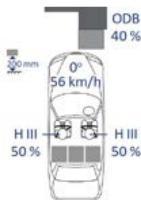
شکل ۱۸. شماتیک آزمون استاندارد ایمنی تصادف از روبه‌رو جزئی Art 18 ژاپن [۱]
