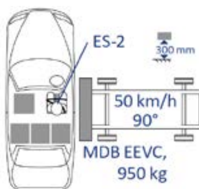
شکل ۲۰. شماتیک آزمون استاندارد ایمنی تصادف جانبی با ستون Art18 ژاپن [۱]
