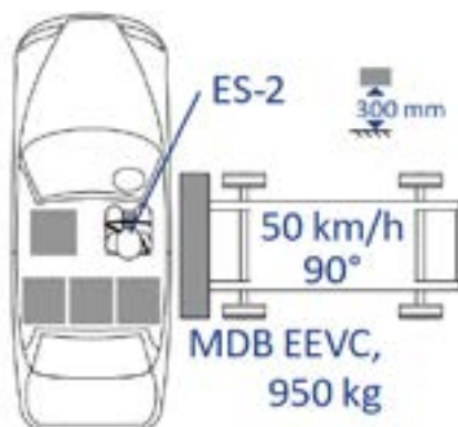
شکل ۳۰. شماتیک آزمون استاندارد ایمنی تصادف جانبی با مانع ADR 72/00-01 استرالیا [۱]
