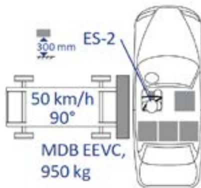
شکل ۸. شماتیک آزمون استاندارد ایمنی تصادف جانبی با مانع ECER95 اروپا [۱]
