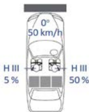
شکل ۱۷. شماتیک آزمون استاندارد ایمنی تصادف از روبه‌رو کامل Art 18 ژاپن [۱]
