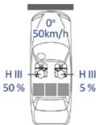
شکل ۲۱. شماتیک آزمون استاندارد ایمنی تصادف از روبه‌رو کامل AIS 201 هند [۱]
