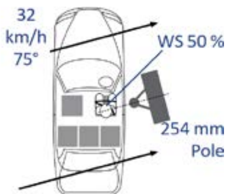
شکل ۲۰. شماتیک آزمون استاندارد ایمنی تصادف جانبی با ستون Art18 ژاپن [۱]
