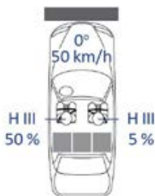
شکل ۶. شماتیک آزمون استاندارد ایمنی تصادف از روبه‌رو کامل ECER137 اروپا [۱]
