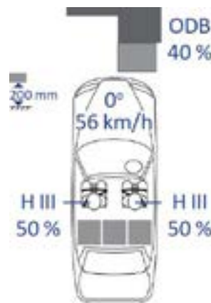
شکل ۲۲. شماتیک آزمون استاندارد ایمنی تصادف از روبه‌رو جزئی AIS 098 هند [۱]
