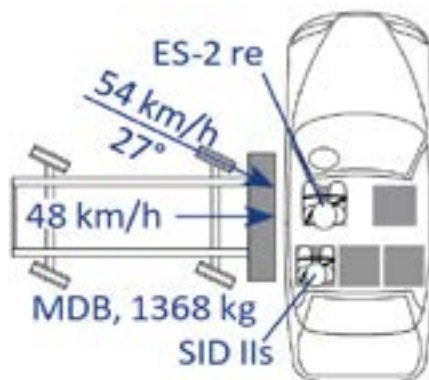
شکل ۳. شماتیک آزمون استاندارد ایمنی تصادف جانبی با مانع FMVSS 214 آمریکا [۱]
