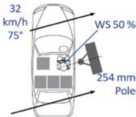
شکل ۳۱. شماتیک آزمون استاندارد ایمنی تصادف جانبی ستون ADR 85/00 استرالیا [۱]
