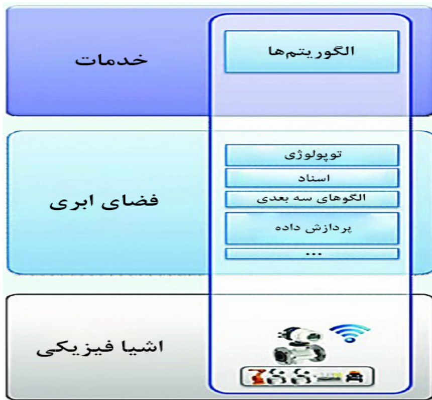
شکل ۱. سطوح اصلی سامانه‌های فیزیکی-سایبری در صنعت ۴.۰
